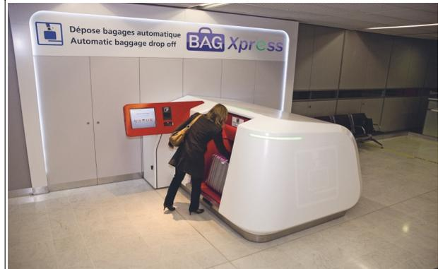
Le système de DBA permet au passager de déposer un bagage en toute autonomie.
