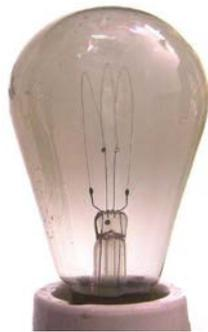
Ampoule au carbone
